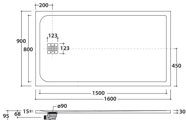
Lo scarico fornito a corredo del piatto in abbinamento alla copertura in acciaio garantisce una efficienza di scarico massima di 24 l/min.
